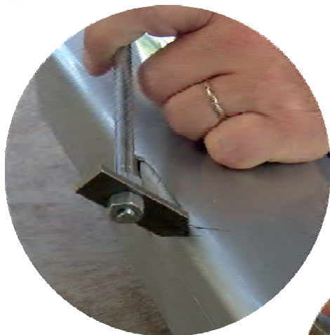
Подготовка на заваръчната междина с двукантов шабер
